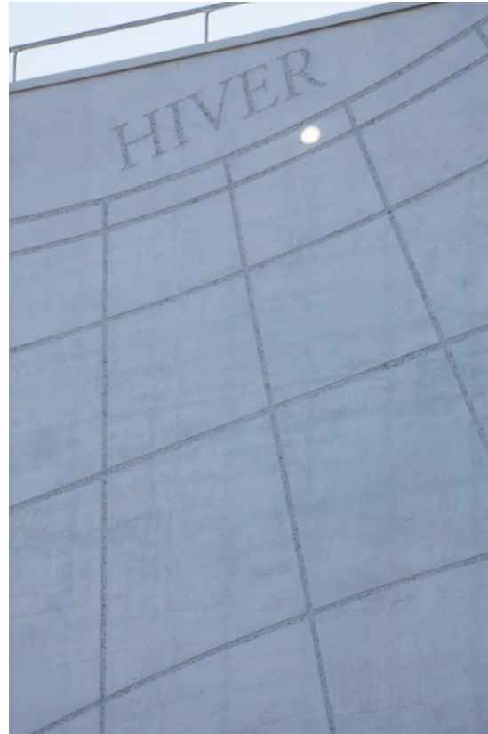
▲ Fig. 20 : Cadran du matin pris en photo quelques jours avant le solstice d'hiver : la tache de lumière indique 10 h 15 m temps solaire vrai (photo Mathieu Ducros).
