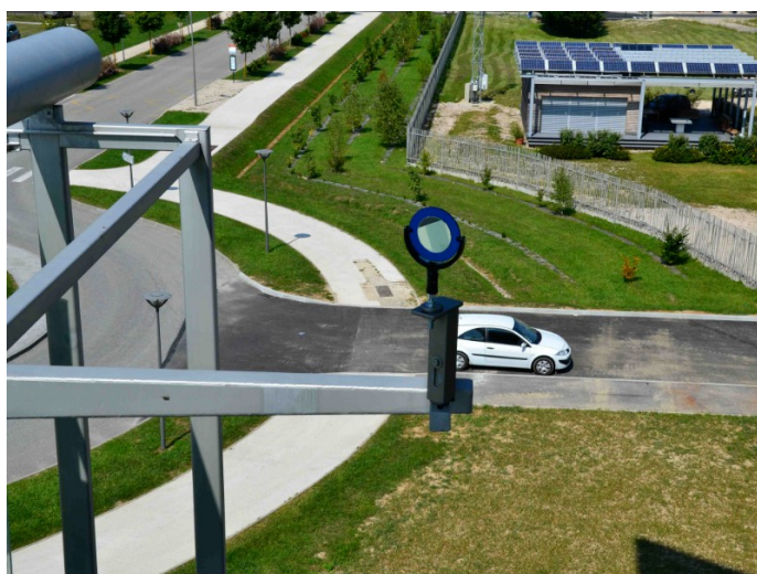
Fig. 8 : Détail du miroir 2 placé sur un bras articulé. Situé à 12,80 m du sol, c'est un miroir de 10 cm de diamètre qui regarde à 10° du Sud vers l'Ouest et est incliné de 4° sous la ligne d'horizon.
